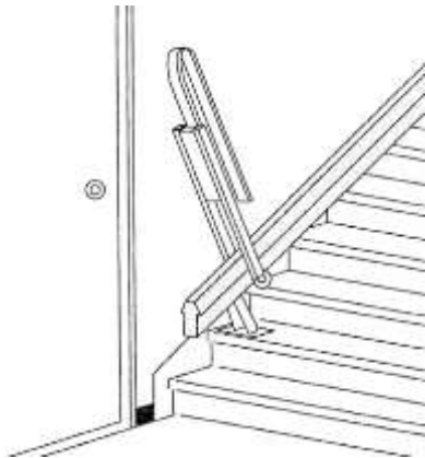
下部折り上げレール
